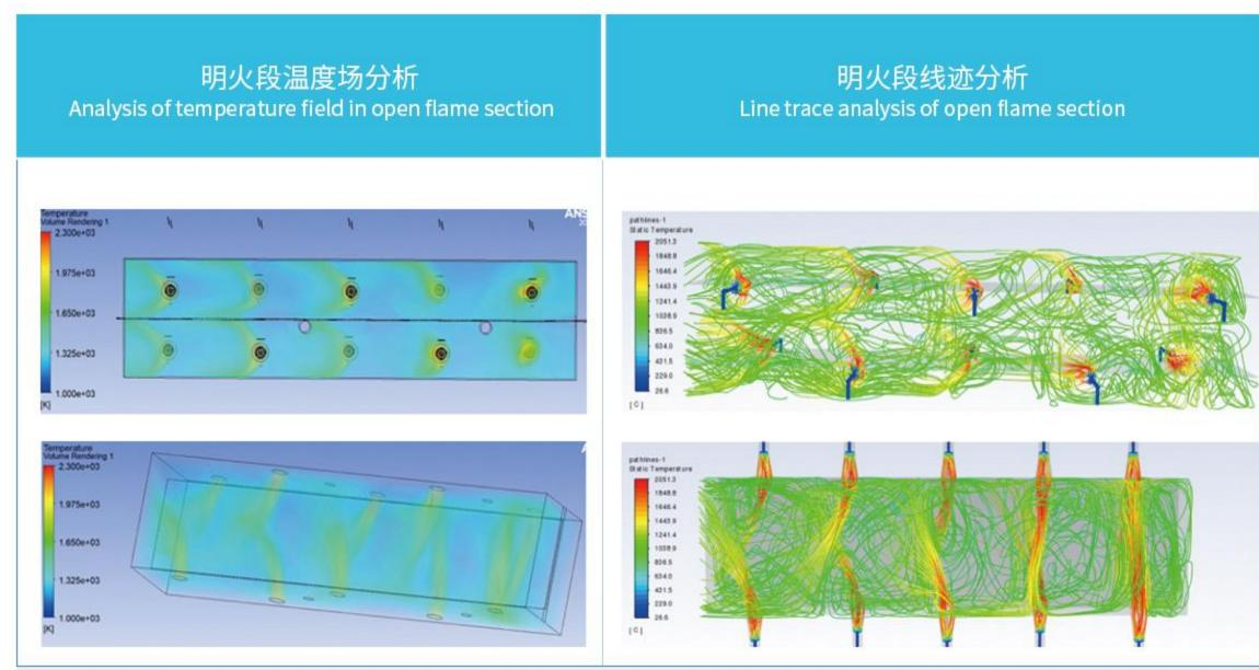
通过比较经验值调整流体动态计算参数,对炉区进行流场及热力学仿真分析,进一步验算设计选型及布局的合理性,将热工的效率发挥至最佳。
